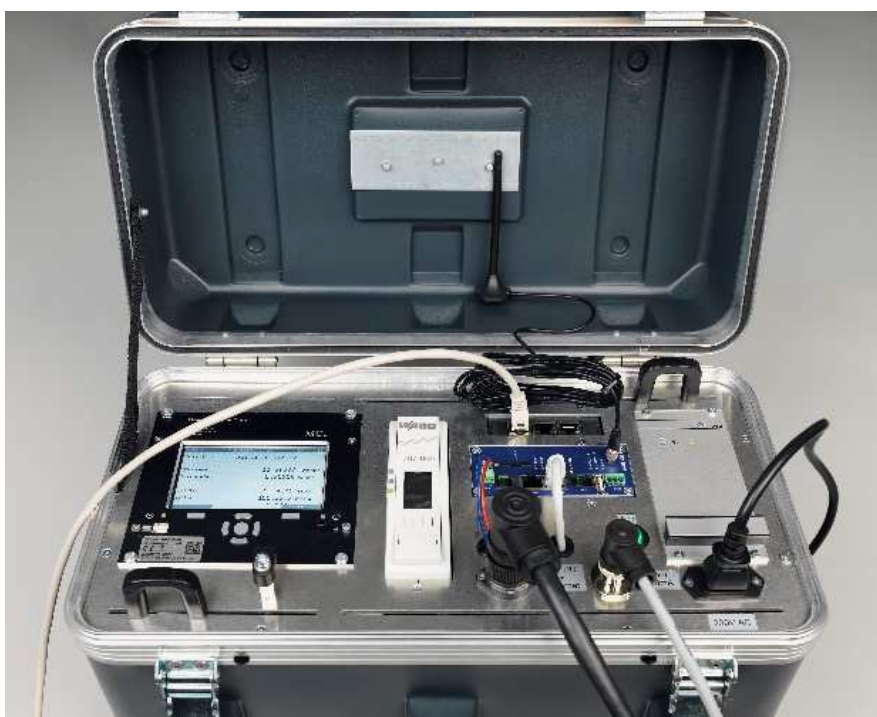
Obrázok č.6 Hlavný displej a dátová pamäť enCore MC1 na MGCflex-m
