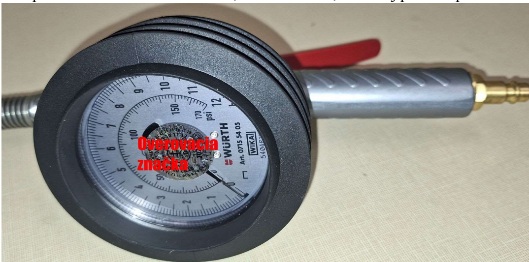
Mechanicke vyhotovenie a umiestnenie overovacej značky
