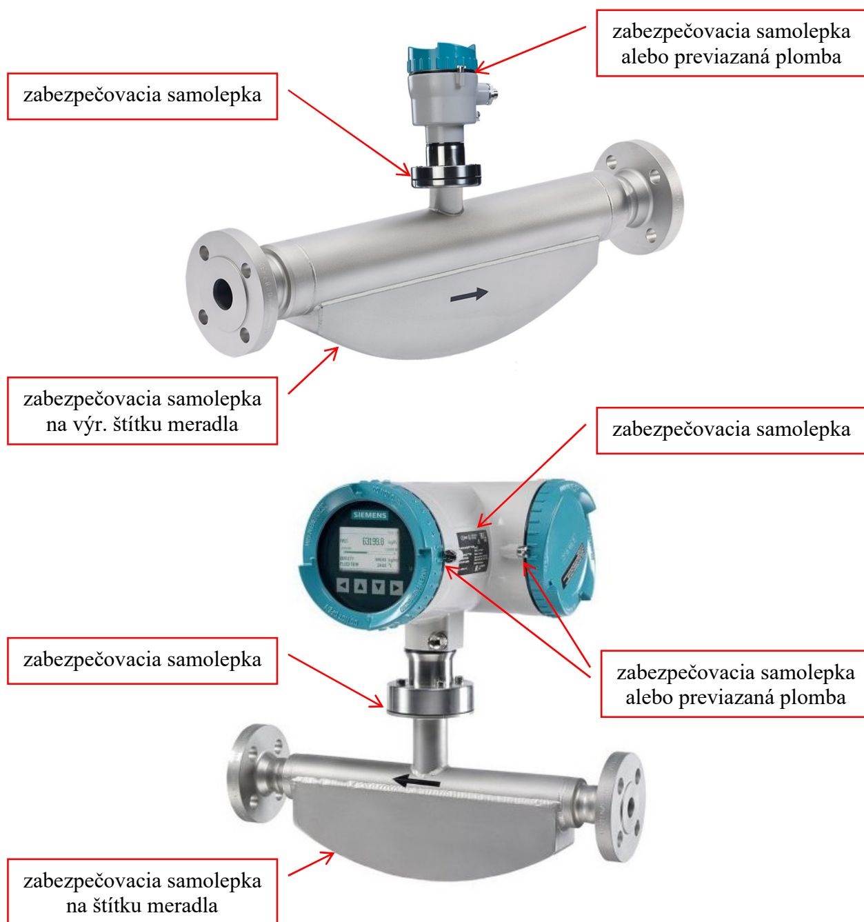
Obr. 6 – Umiestnenie overovacích a zabezpečovacích značiek na snímači meradla (kompaktná i oddelená verzia)
